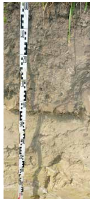
Für die Bodenbeurteilung wird an einer Stelle, in heterogenen Parzellen an mehreren Stellen, eine Grube mit einer für beste Lichtverhältnisse nach Süden ausgerichteten Profilwand ausgehoben. Das Profil darf beim Graben mit den Werkzeugen nicht verdichtet werden. Die Beurteilung des Profils sollte mit Notizen und Fotos festgehalten werden. Die Verwendung spezifischer Formulare und das Beiziehen einer Fachperson können eine wertvolle Unterstützung sein.
